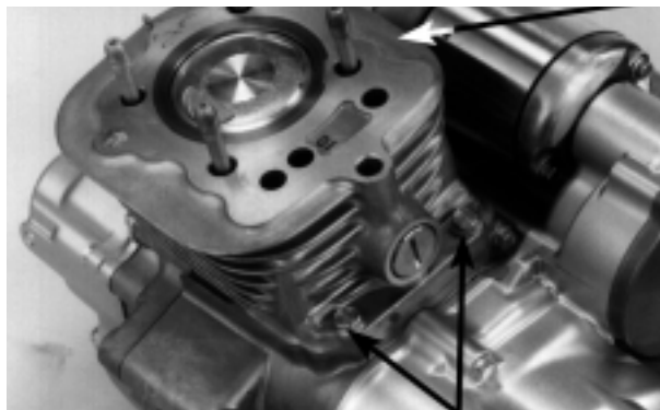
PARAFUSOS DE FIXAÇÃO DO CILINDRO
