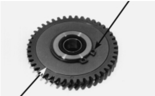
MOLA DE ENCOSTO ENGRENAGEM A MOLA DA ENGRENAGEM MOVIDA
